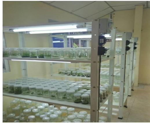
ชั้นวางขวดหลังจากประกอบและติดตั้งระบบไฟ
